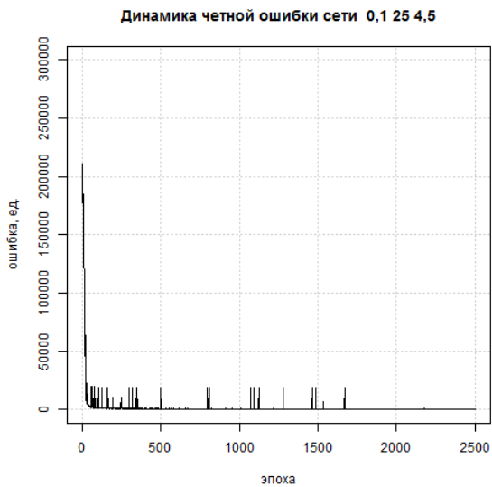
Рис. 3. Динамика чётной ошибки сети при параметрах ПИД-регулятора 0.1, 25, 4.5
