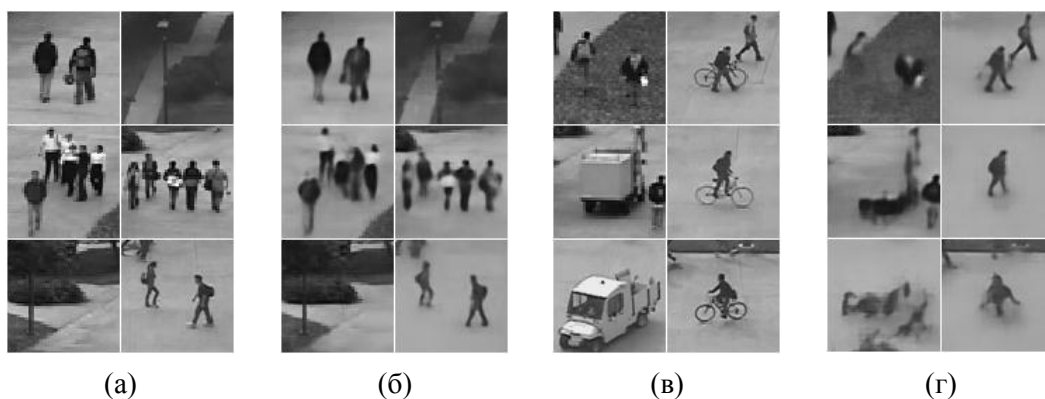
Рис. 1. Примеры нормальных (а) и аномальных (в) областей входных изображений и их соответствующие (б, г) реконструкции моделью FCVAE
