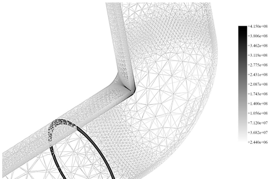
Рис. 1. Карта напряжений в углу изгиба трубы
